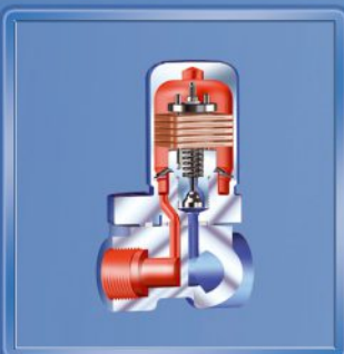
CONA ® Conector Universal permite a manutenção ou troca dos purgadores de forma rápida e fácil.
