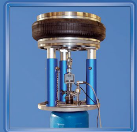
Dispositivo patenteado de verificação de válvulas instaladas sem elevação da pressão da caldeira ou perdas de fluido
