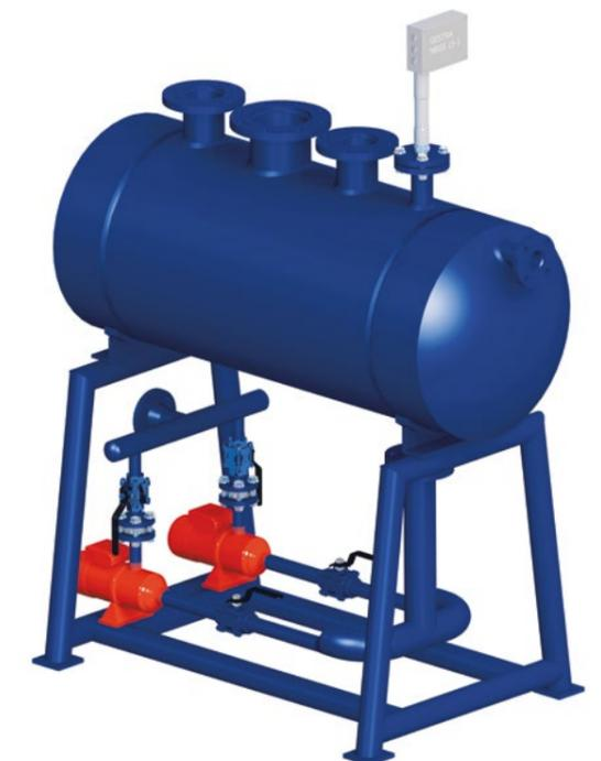
A bomba de condensado Bermo, é utilizada para transferir condensado ou outros fluidos que se encontram a baixas pressões ou vácuo para o desaerador, reservatório de condensado ou água de alimentação, sem o uso de energia elétrica. Outra aplicação bastante comum da bomba de condensado Bermo é em áreas classificadas como na elevação do condensado a altas temperaturas.
