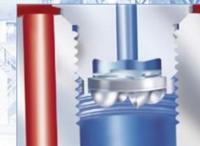
Proteção contra golpes de aríete para garantir uma longa vida útil com válvula de retenção incorporada.
