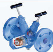
Purgadores com tecnologia multiválvulas CONA® "All-in-One" (inclui válvulas de bloqueio, retenção, dreno e filtro interno)
